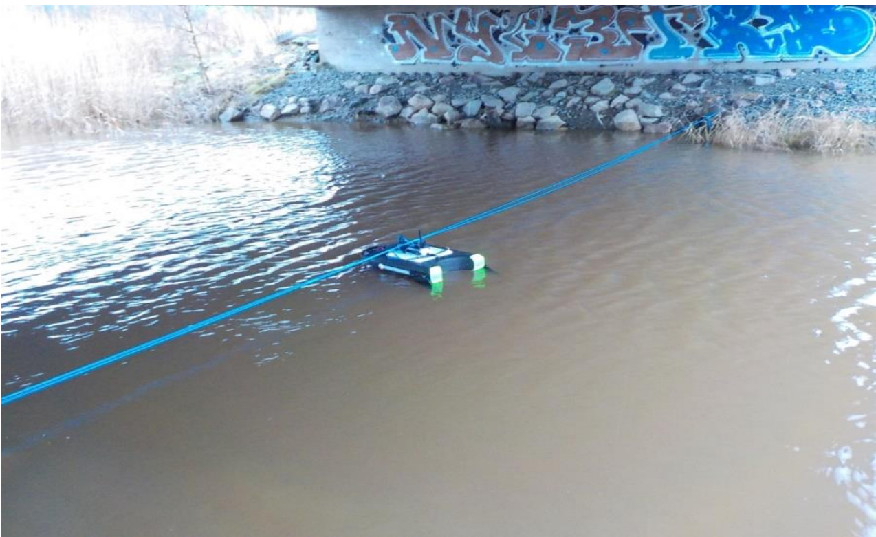
Virtaamamittausta Hirvijoella Turku-Kustavi maantiesillalla 1.12.2020 (kuva: Pasi Salmi).
