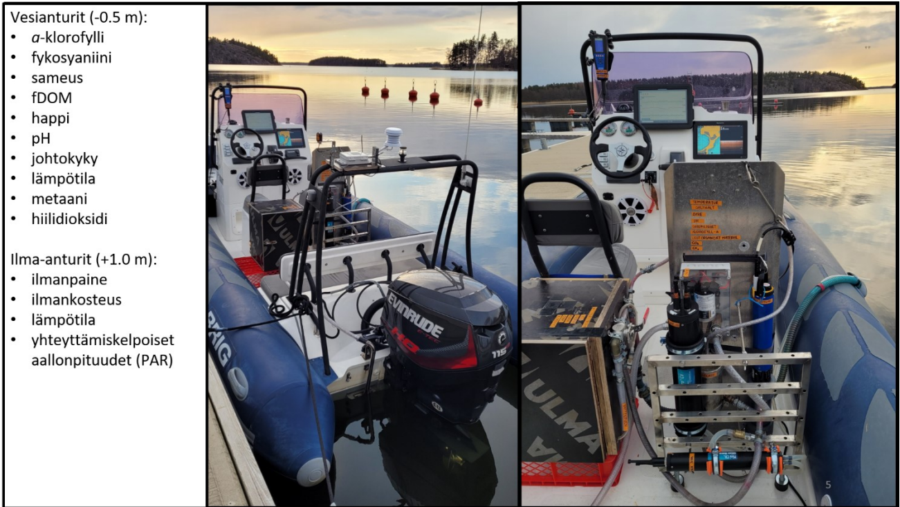
Kuva 3. Avoveneeseen asennettu läpivirtausjärjestelmä ja kartoituksissa käytetyt anturit. Mitattujen muuttujien lukumäärä on huomattavasti antureiden lukumäärää korkeampi, koska useat mittaustuottajat määritetään laskennallisesti muiden muuttujien perusteella. Vedenlaatuindikaattoreista tulosten tarkastelussa kiinnitetään huomiota erityisesti sameuteen, (fluoresoivaan) liukoiseen eloperäiseen ainekseen (fDOM) sekä \alpha -klorofylliin.
