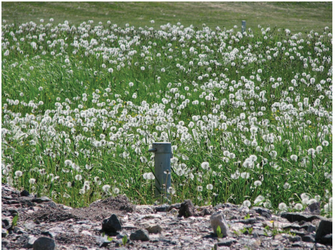
Kuva 10. Pohjaveden havaintoputki PVP1 Murikon käytöstä poistetulla sorakuopalla.
